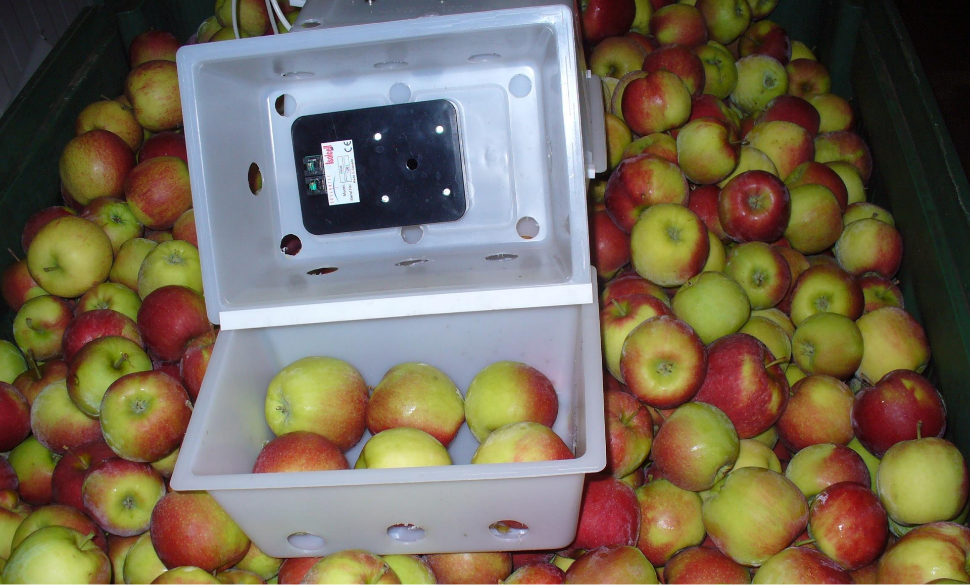
Ticari bir DCA odasında Jonagold elma çeşidinde Klorofil-Fluoresans sensörü ('Harvest Watch™')
